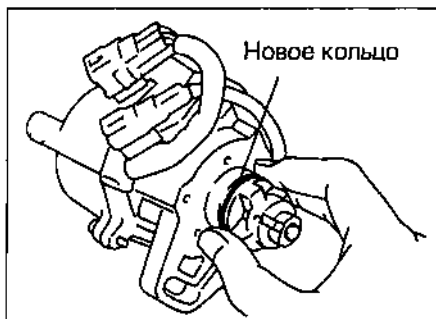
Рис. 9.8. Установите новое уплотнительное кольцо на корпус распределителя
