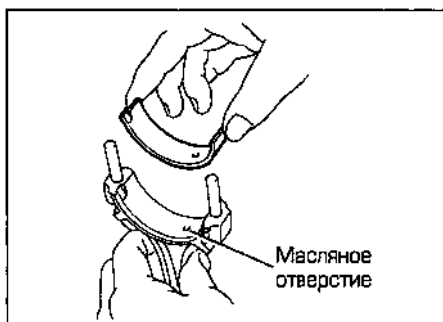
Рис. 25.3. Совместите масляные отверстия в шатуне и во вкладыше
