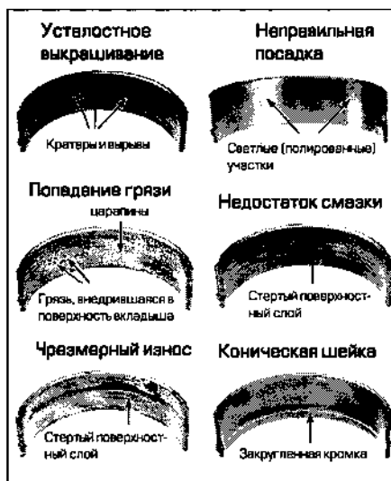
Рис. 20.1. Типичные виды повреждений вкладышей подшипников
