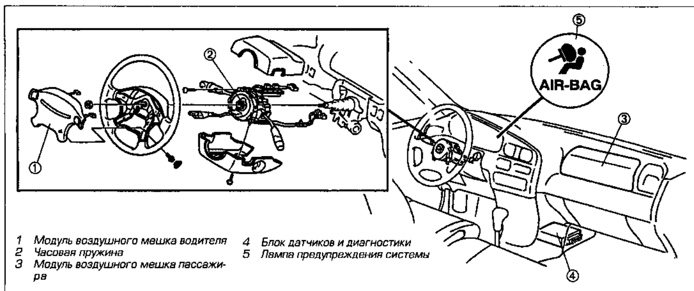
Рис. 25.1. Компоненты типичной системы воздушного мешка
