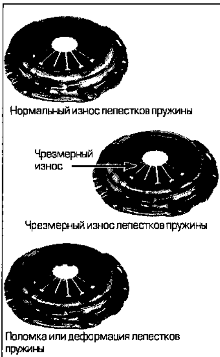
Рис. 3.12, б. Замените нажимной диск при следующих неисправностях
